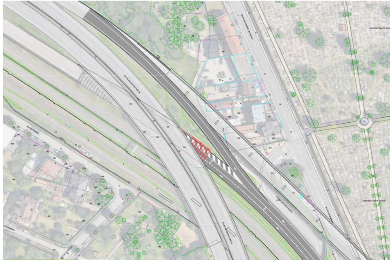
Figure 12 : Vue en plan de la future bretelle vers la M35 (source : AVP GESTAS)
