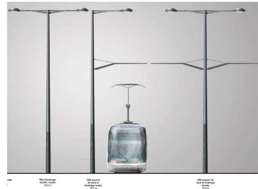
Figure 267 : Exemple de poteaux simples avec éclairage et poteaux avec console et éclairage (source : GETAS)
