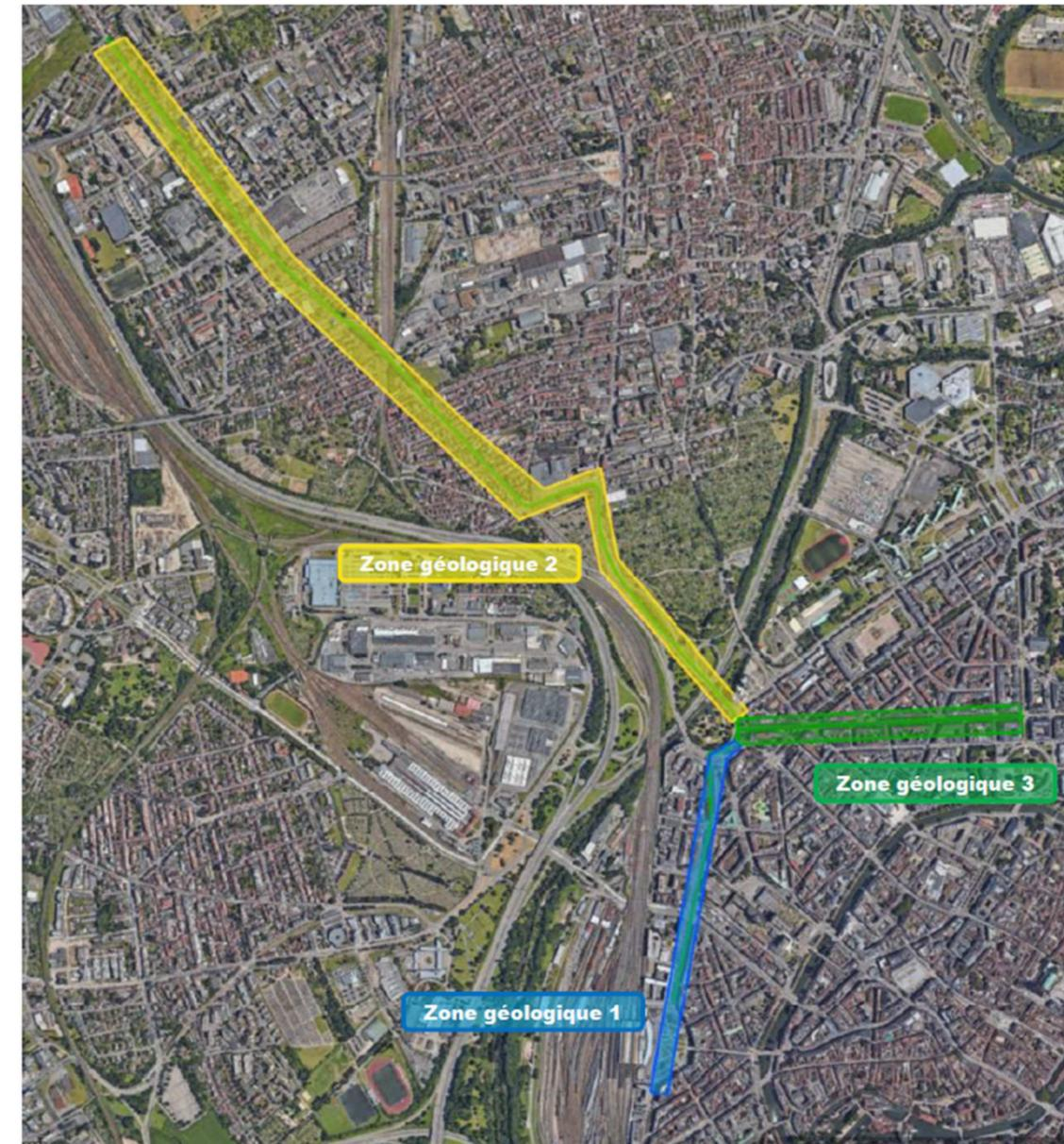
Figure 287 : Découpage du tracé en zones géologiques homogènes
