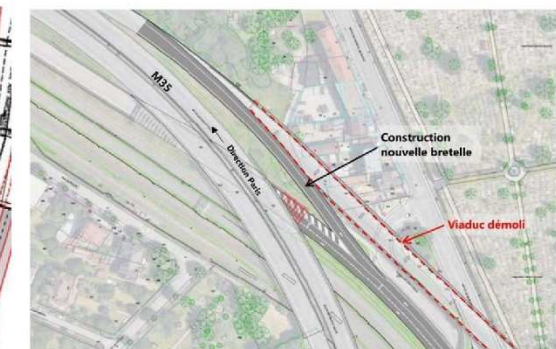
Figure 12: Modification de l'échangeur M263-M35
