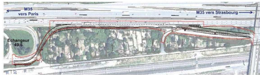
Figure 8: Ajout d'une bretelle sur l'échangeur de Hoenheim
